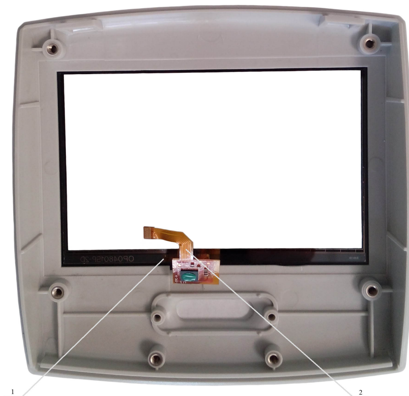
Рисунок 4.19 - Сенсорная панель в передней панели корпуса монитора МГА-06, где
