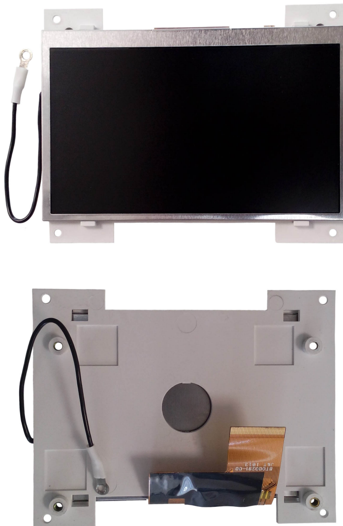
Рисунок 4.18 - Лицевая и обратная стороны LCD-дисплея монитора МГА-06
