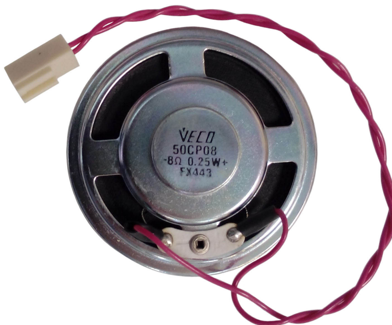
Рисунок 4.22 - Звуковая динамическая головка прибора МГА-06
