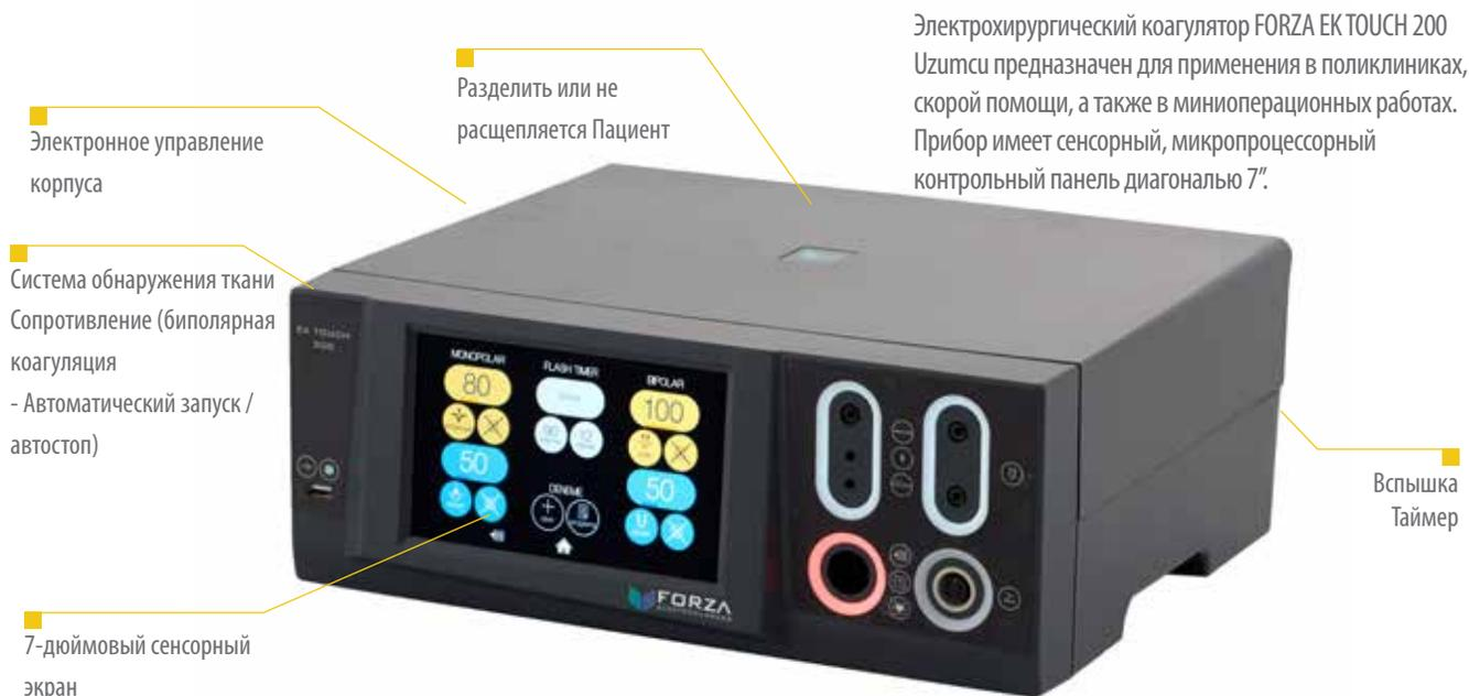
Электрохирургический коагулятор FORZA EK TOUCH 200 Uzumcu предназначен для применения в поликлиниках, скорой помощи, а также в миниоперационных работах. Прибор имеет сенсорный, микропроцессорный контрольный панель диагональю 7".
