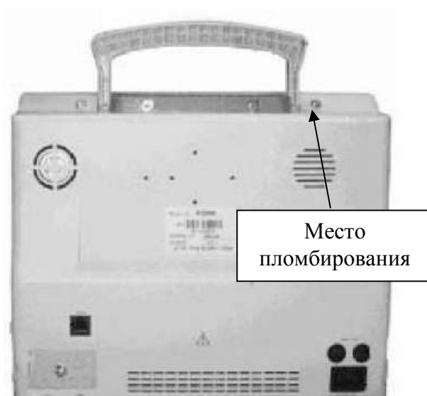
Рисунок 2. Монитор пациента модели Beneview T5. Вид сзади.
