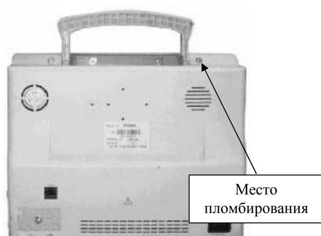
Рисунок 2. Монитор пациента модели Beneview T5. Вид сзади.
