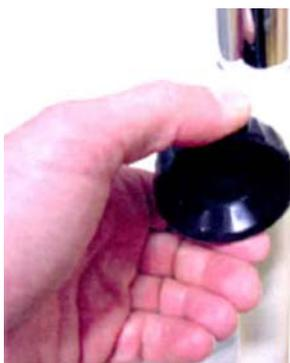
Проверьте, плотно ли затянут винт, во избежание падения головы. С помощью этого винта можно производить грубую настройку положения головы по высоте.
