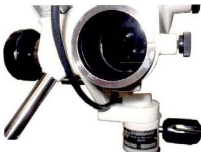
Вставьте полученную комбинацию в гнездо, подключите к ней кабель USB, а другой конец кабеля подключите к компьютеру:
