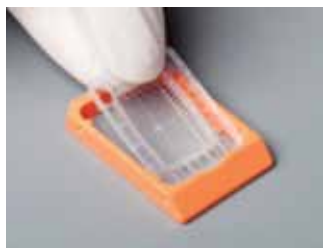
Фиксация кассеты Paraform в рамке
